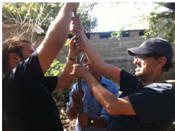
Figura 13. El equipo técnico realizando sondeos para el estudio de suelo
