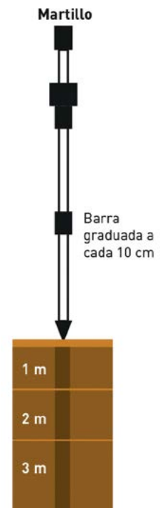
Figura 1. Esquema de la herramienta para la prueba de cono dinámico
